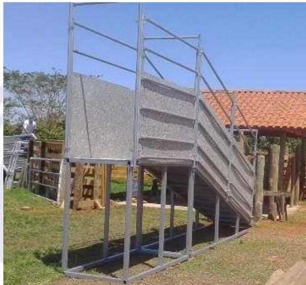
Figura 16 – Exemplo de embarcador para bovinos
