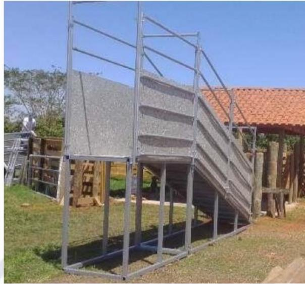
Figura 20 – Exemplo de embarcador para bovinos
